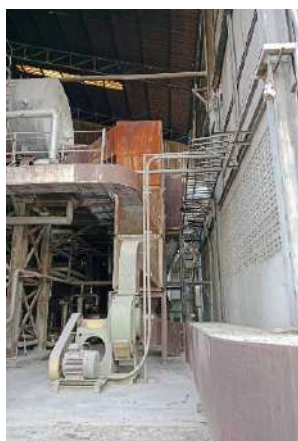
รูปที่ 2-31 อุปกรณ์ดูดฝุ่น (Local Exhaust)
